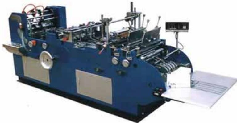
**Machine de fabrication d'enveloppes entièrement automatique ZF 390**
